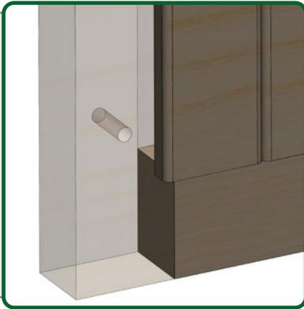
Forare il telaio con una punta da 14 mm.
