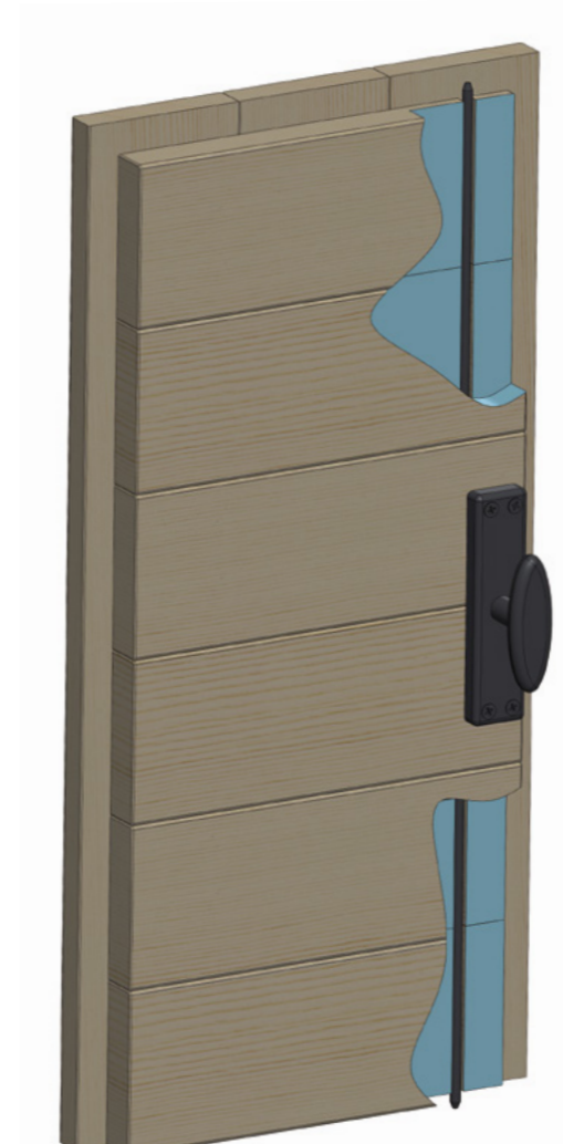
APPLICAZIONE DELL'ASTA INTERNA APPLICATION OF INTERNAL ROD
