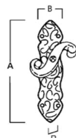
Cremonese a incasso Recessed cremone bolt Martellina con placca T handle with plate
